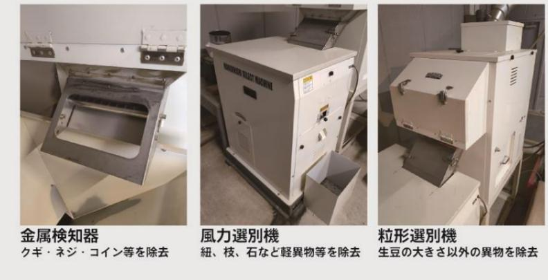
金属検知器 クギ・ネジ・コイン等を除去
