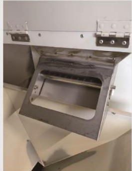
金属検知器 クギ・ネジ・コイン等を除去
