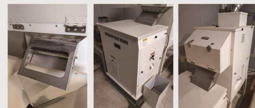
金属検知器 クギ・ネジ・コイン等を除去 風力選別機 紐、枝、石など軽異物等を除去 粒形選別機 生豆の大きさ以外の異物を除去
