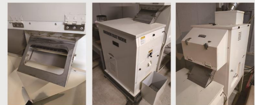
金属検知器 クギ・ネジ・コイン等を除去 風力選別機 紐、枝、石など軽異物を除去 粒形選別機 生豆の大きさ以外の異物を除去
